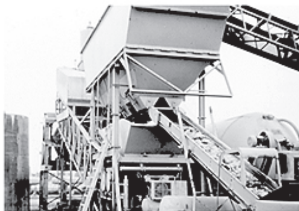
شکل ۱-۲۳- اضافه کردن الیاف فولادی به وی بچر
