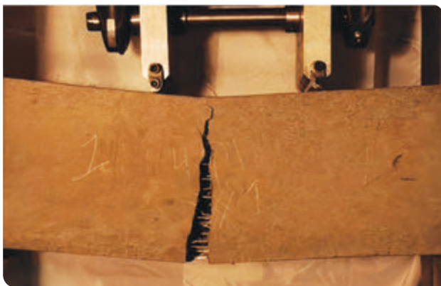
شکل ۱-۵- تصویری از گسیختگی خمشی تیر بتن الیافی
