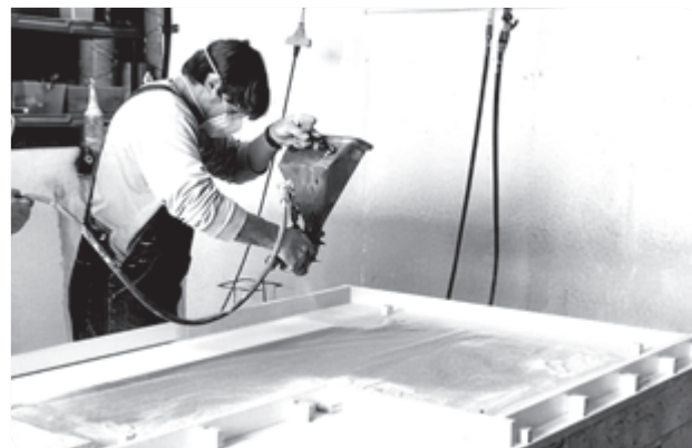
شکل ۱-۳- تصویری از اجرای بتن الیافی شیشه‌ای
