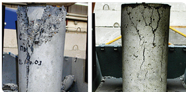
شکل ۱-۴- تفاوت گسیختگی در آزمون بتن معمولی (سمت چپ) و الیافی (سمت راست)
